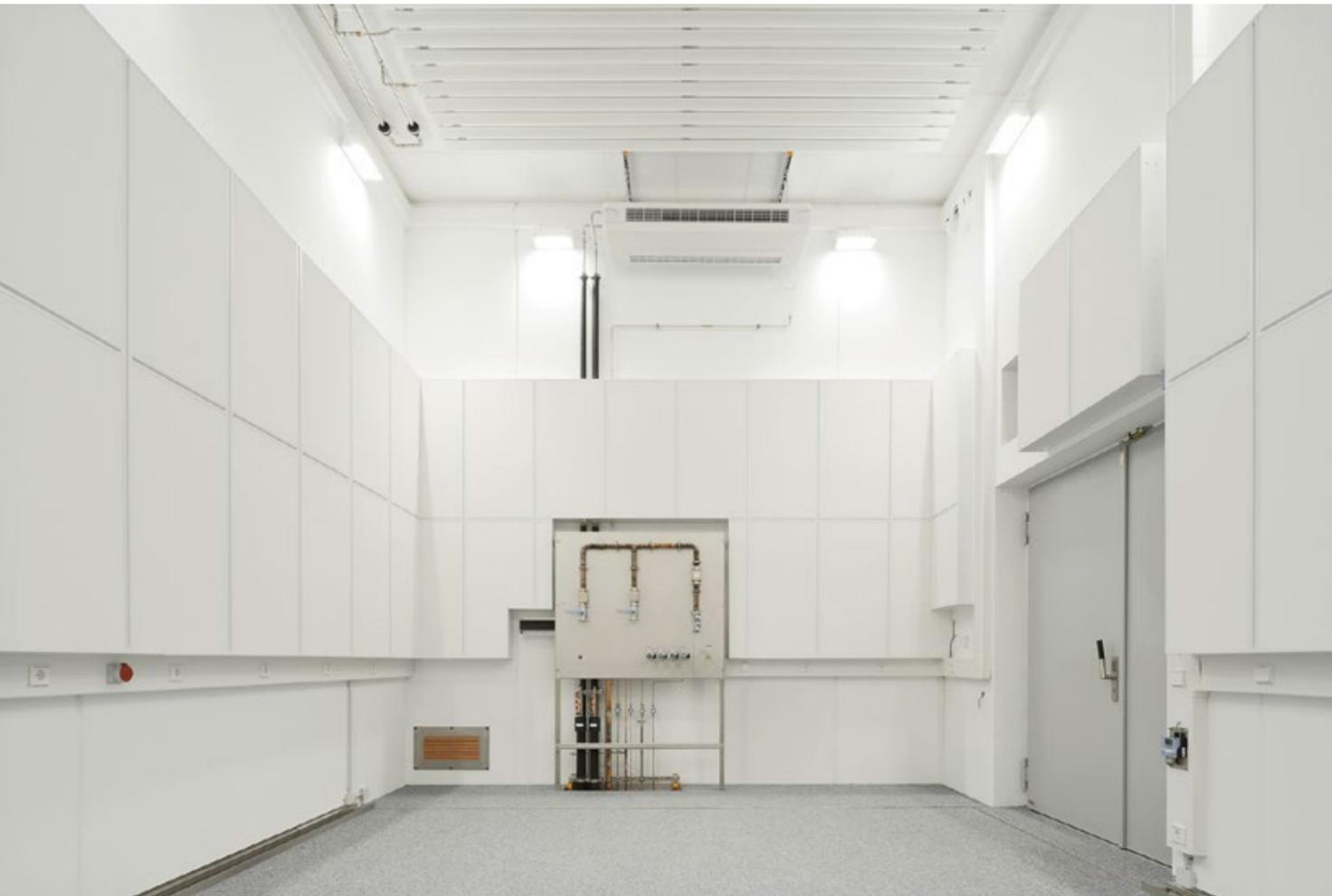
Die optimale Abschirmung der Experimente vor äußeren Einflüssen ist nach dem Schalenprinzip aufgebaut: Der Versuchstisch ist durch den Kubus, der Kubus durch die Halle und die Halle durch die umgebenden Räume geschützt.
